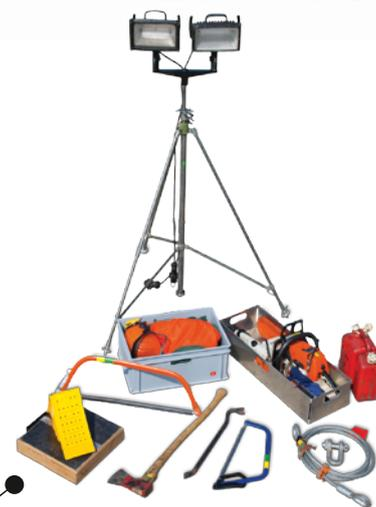
**1000-W-Strahler, Stativ, Strahlerbrücke**
