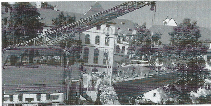
Einsetzen unseres K-Bootes mit der DLK 23/12 (Kranrüstung) an schwer zugänglichen Stellen.
