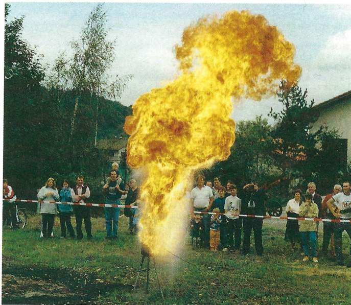
Fettbrand nach Löschversuch mit Wasser. Drei Liter brennendes Öl und ein Schnapsglas Wasser ergibt diese Fettexplosion.
