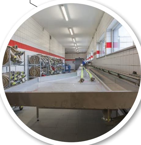
Schlauchpflegeanlage mit 20 Meter Länge, Druckprüfstation und Aufwickelmaschine
