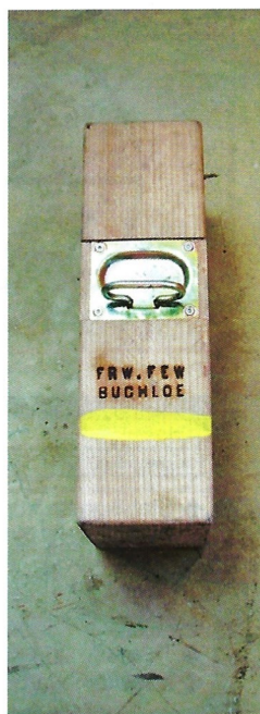
Je Unterbaupunkt ein großer Holzklötz mit Handgriff
