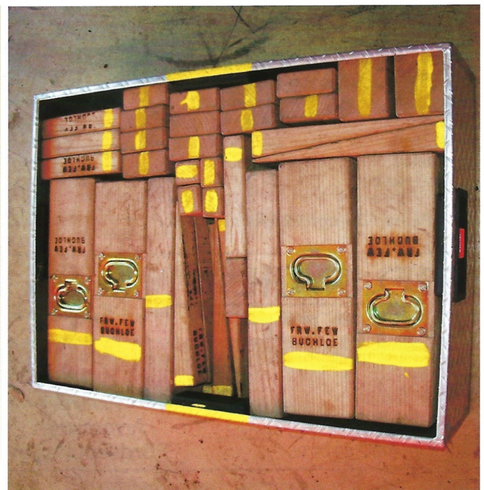
Unterbaumaterial LF 16 /12. Holzklötze und Keile aus Hartholz
