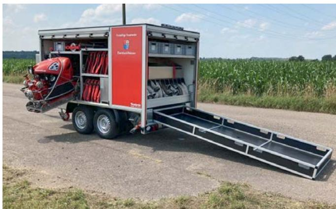
**Tragkraftspritzenanhänger mit B-500 Komponente der Feuerwehr Ebersbach/Außengruppe Heißen**
