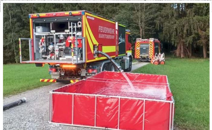
Der Abrollbehälter Wasser fasst 8.000 Liter Löschwasser.
