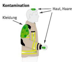
Abb. 2: Kontamination durch ABC-Gefahrstoffe
