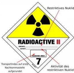
Die Transportkennzahl (TKZ) mit 10 multipliziert ergibt die in 1 m Entfernung von der Oberfläche der intakten Verpackung gemessenen Äquivalentdosisleistung in  $\mu\text{Sv/h}$
