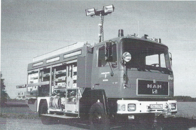
RW 2 der Freiwilligen Feuerwehr Buchloe auf MAN-Fahrgestell (12 222 Euro 2 Motor) mit Ziegler Aufbau. Beladung und Geräte. Zugeinrichtung 50-KN-Winde, 20-KVA-Stromerzeuger, 5-KVA-Notstromaggregat tragbar, Ölschaden-Ausrüstung, leichte und schwere Chernieschutzkleidung, 6-Meter-Lichtmast mit 2 x 1500-Watt-Scheinwerfer, Auer Be- und Entlüftungsgesät, Hydraulikaggregat mit 20 Meter Schlauchleitung für Spreiz- und Schneidgerät, drei Größen Rettungszylinder, 8 bar- und 1,5 bar-Hebekissen, integrierte Umfeldbeleuchtung.
