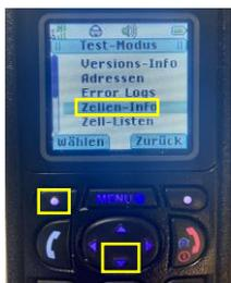
Mit der Richtungstaste unten „Zellen-Info“ anwählen, linken Button „Wählen“ drücken, abschließend noch Richtungstaste „rechts“
