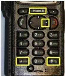
Gerät einschalten, Tastenkombination \*# (Stern, Raute), Menütaste, und Navigationstaste rechts drücken.
