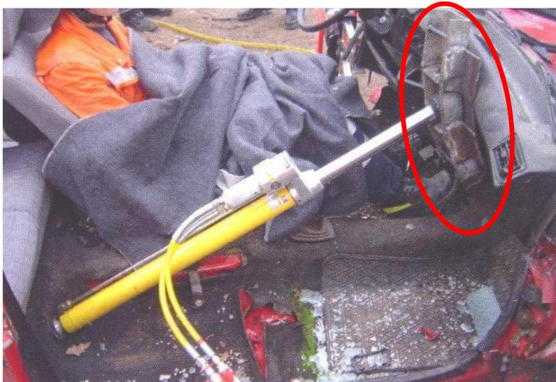
Abbildung 7: Armaturenrettungskralle BF Augsburg
