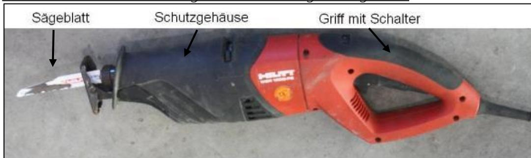
Abbildung 18: Aufbau einer Säbelsäge
