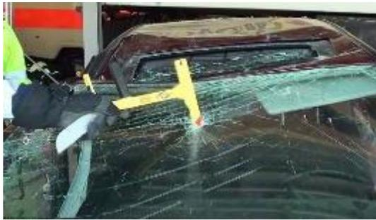
Variante 2: Entfernen der Scheibe(n) (Verbund-Sicherheitsglas - VSG) durch Glassäge
