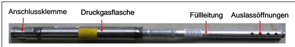
Abbildung 19: Hybridgenerator Kopfairbag Seat Exeo
