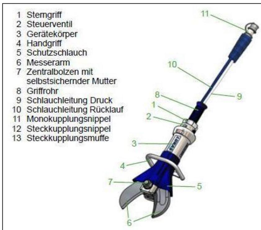
Abbildung 13: Aufbau Schneidgerät Quelle: Homepage Lukas Hydraulik GmbH, Deutschland: <http://www.lukas.de>; Stand: 01.07.2010
