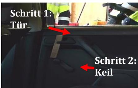
**Tipp!** Wenn **nach** der Türschlossentriegelung ein Keil oder ein Gegenstand im inneren Türgriff fixiert wird, ist das Türschloss freigegeben und die Öffnung der Tür wird erleichtert.
