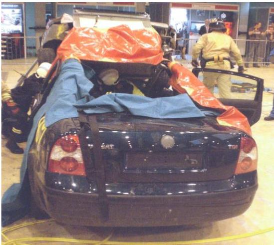
Abbildung 10: Einschneiden und Umklappen des Daches [6]
