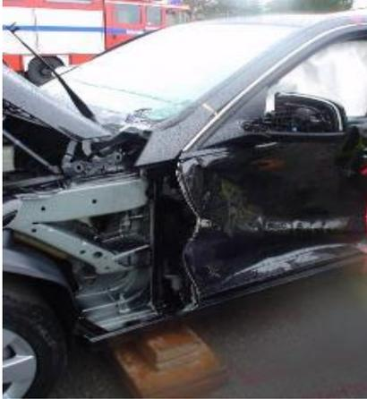
Zum Entfernen der Tür müssen die Scharniere und das Schloss der Tür mit den hydraulischen Rettungsgeräten abgetrennt werden.
