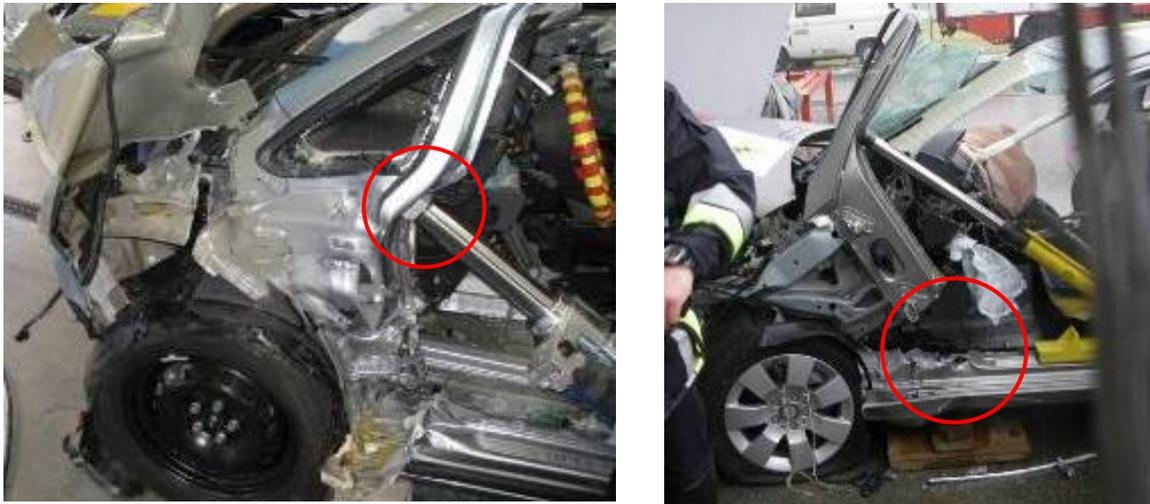
Abbildung 2: li.: A-Säule eingedrückt; re.: A-Säule dreht heraus
