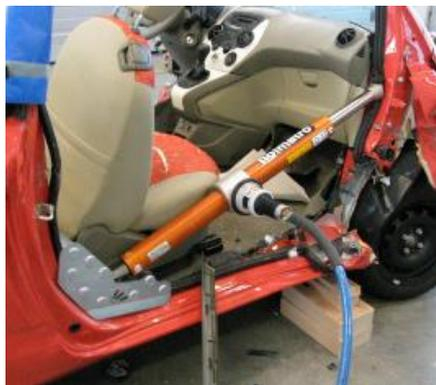
Variante 1: Fußraumerweiterung durch Zylindereinsatz
