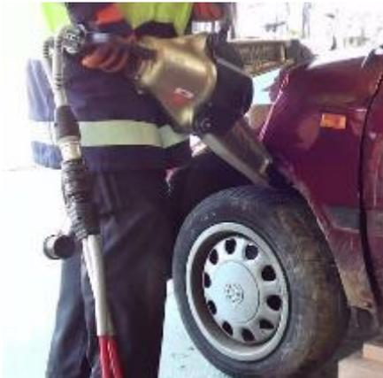
Variante 1: Türspalt durch Kotflügel zusammendrücken
