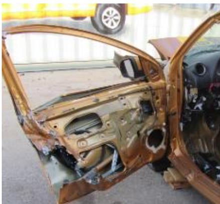
**Tipp!** Wenn **nach** der Türschlossentriegelung ein Keil oder ein Gegenstand im inneren Türgriff fixiert wird, ist das Türschloss freigegeben und die Öffnung der Tür wird erleichtert.
