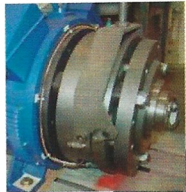
ROBA-stop® Bremse Einsatz im neuen Schrägaufzug der Oberstdorfer Schattenberg-Schanze
